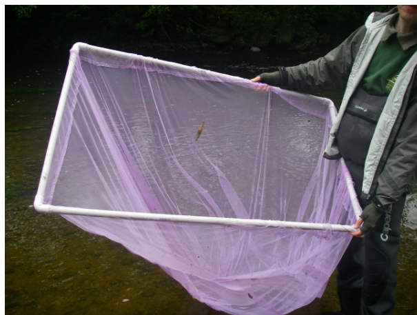
Photo n°10 : Filet à mailles fines manipulé à la main pour la capture des alosons
