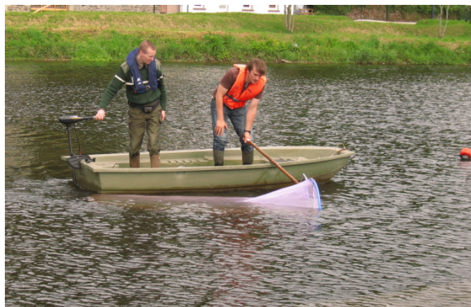
Photo n°9 : Capture au filet à mailles fines tracté par une embarcation à motorisation électrique
