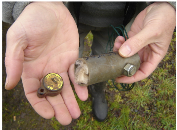
Photo n°6 : Sonde thermique « TidBit » fixée dans le lit de la rivière
