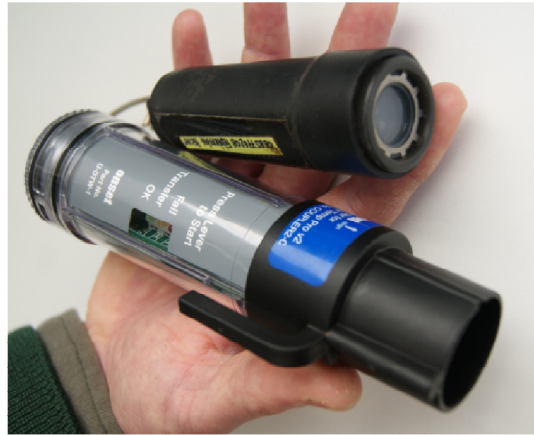
Photo n°6 : Sonde thermique installée dans le lit de la rivière et navette de récupération de données HOBO Water Temp Pro v2
