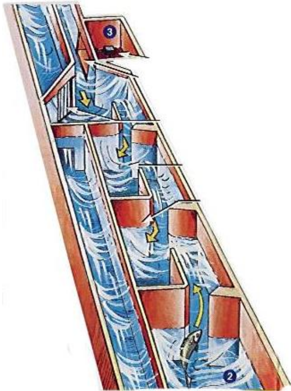
Figure 1.- Reconstitution pédagogique vue de dessus et en 3D de la passe à bassins du barrage d'Arzal.
