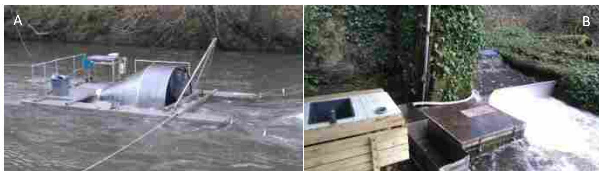
Figure 5 : Système de piégeage pour capturer les smolts de saumon atlantique et de truite de mer dans le cadre du projet SAMARCH.
